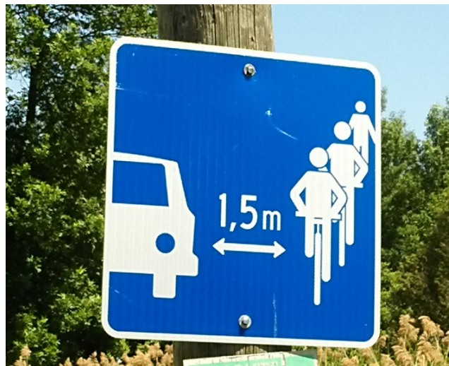
Figure 4. Panneau de distance minimale de dépassement - montée Breault, Saint-Blaise-sur-Richelieu
